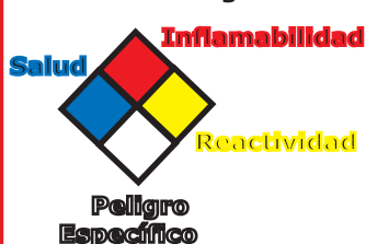
Figura 1. Sistema de Identificación para los Materiales Peligrosos
